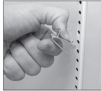
Abb. 1. Anbringen der oberen Lasche des Bodenträgers.
