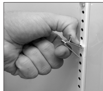
Afb. 2. De onderste clip van de inlegbodem zal stevig vastzitten.
