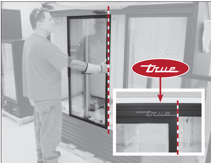
Afb. 6. Lijn de rechterrind van de linkerdeur uit met de rechterrind van het TRUE-logo.
