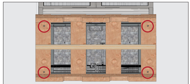
Figure 4. Emplacements des vis de transport.
