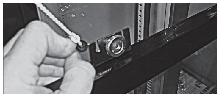
Figure 8. Glissez la languette noire qui maintient le cordon de porte pour le dégager de l'arrière de la patte de galet.
