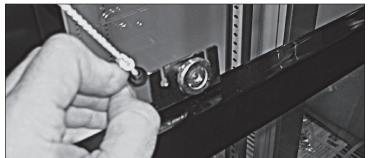
Abb. 8. Lassen Sie die schwarze Lasche, die das Türseil hält, an der Rückseite herausgleiten.
