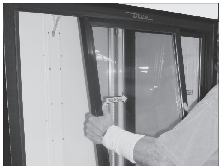
Abb. 4. Entfernen Sie die Tür vorsichtig.
