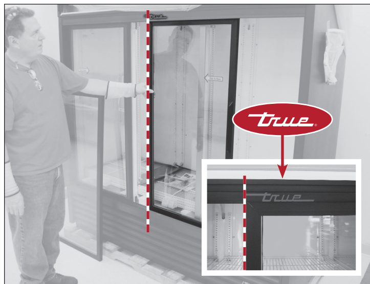
Rys. 5. Wyrównać lewą krawędź prawych drzwi z lewą krawędzią logo TRUE.
