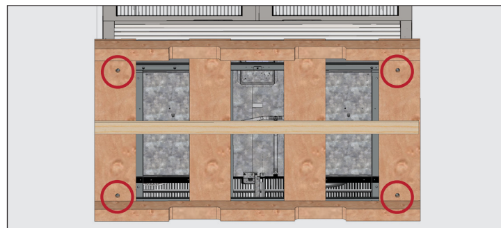
Rys. 4. Lokalizacja śrub transportowych.
