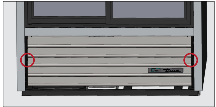
Rys. 2. Lokalizacja wkrętów kratki żaluzji w urządzeniach z drzwiami przesuwymi.
