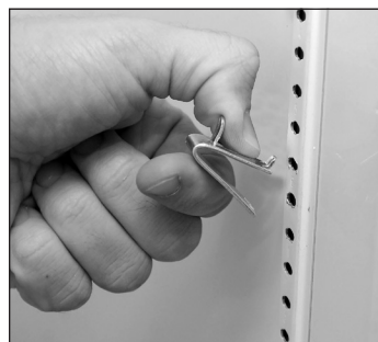
Rys. 1. Wkładanie górnego występu zacisku półki.
