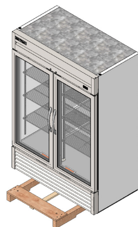
Rys. 5. Jeśli będą używane nóżki poziomujące lub kółka, obrócić urządzenie na palety.
