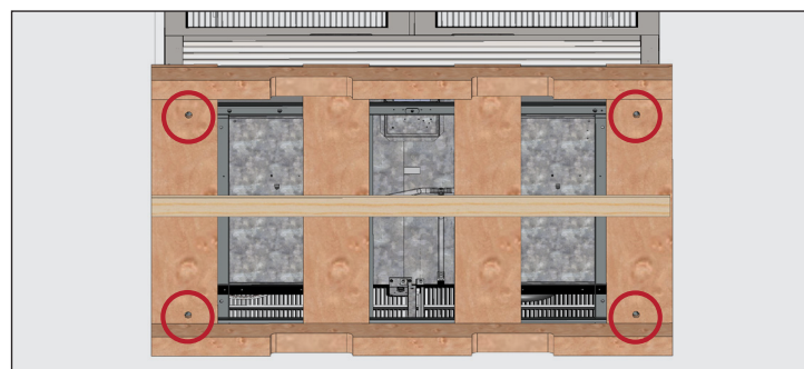
Рис. 4. Местонахождение транспортировочных болтов.
