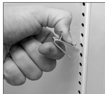
Рис. 1. Установка верхнего язычка кронштейна под полку.
