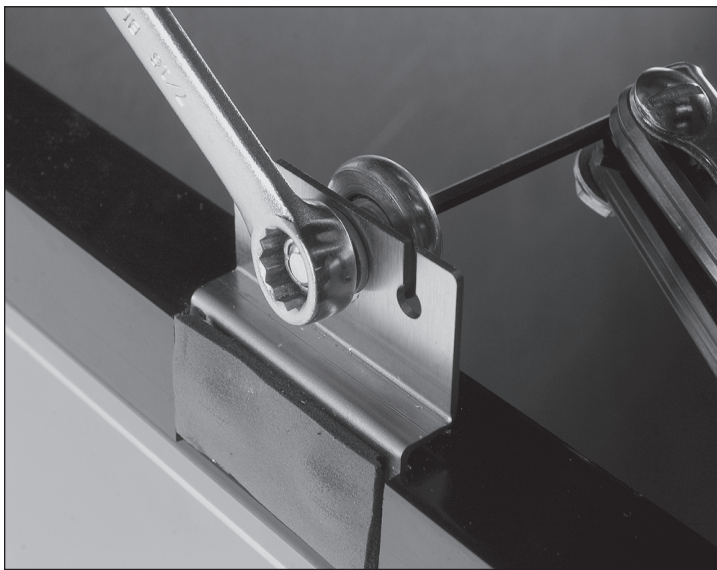
Fig. 1. Ajuste el rodillo.
