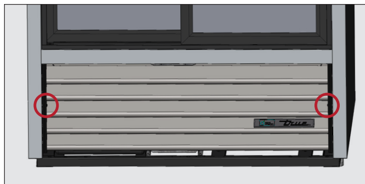
Fig. 2. Ubicaciones de los tornillos de la rejilla apersianada de la puerta corrediza.
