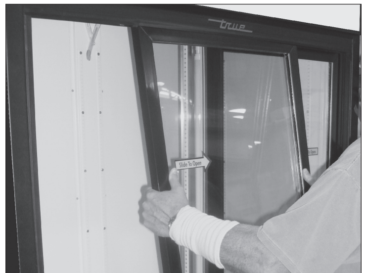
Fig. 4. Retire la puerta con cuidado.
