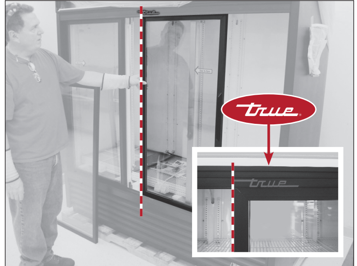
Fig. 5. Alinee el borde izquierdo de la puerta derecha con el borde izquierdo del logotipo de TRUE.
